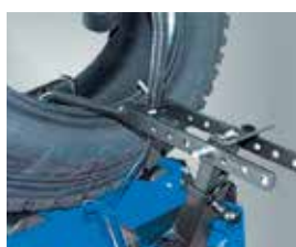
Настройка устройства расширения
